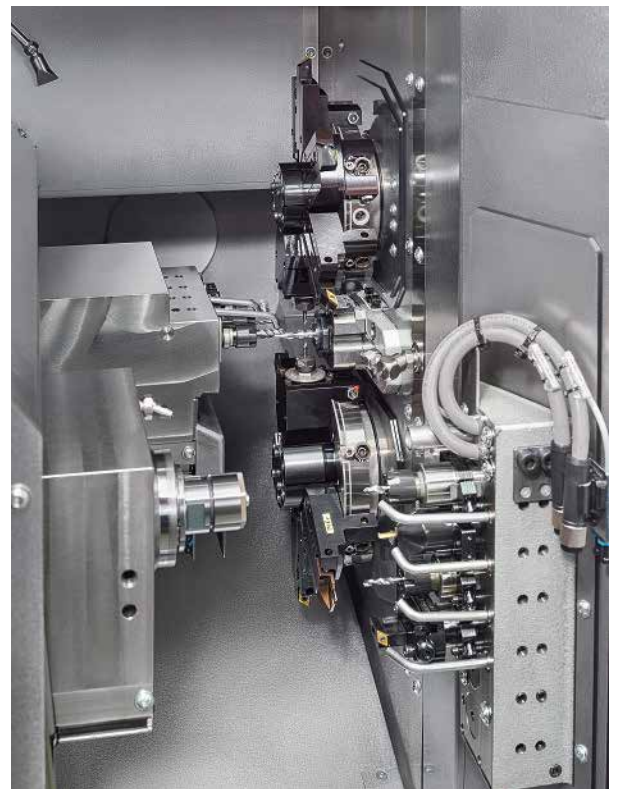
Das Arbeitsraumkonzept der Traub TNL 12 mit zwei Werkzeugrevolvern sowie einem Front- und Rückapparat ermöglicht eine simultane Bearbeitung.
